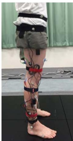
図 3 各種センサーの取り付け位置
